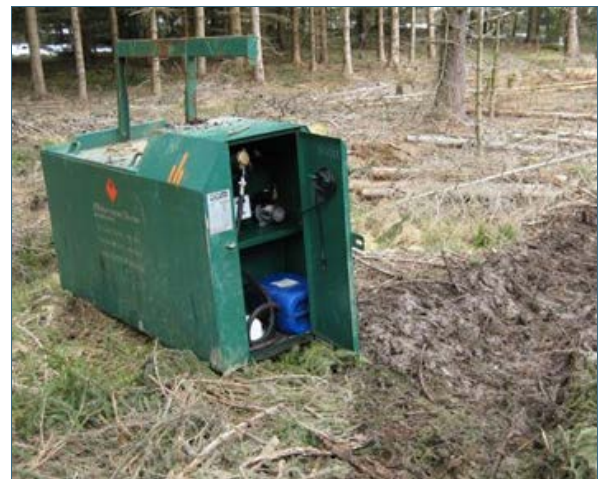
Abb. 5: Bsp. eines mobilen 1000-Liter-Dieseltanks
