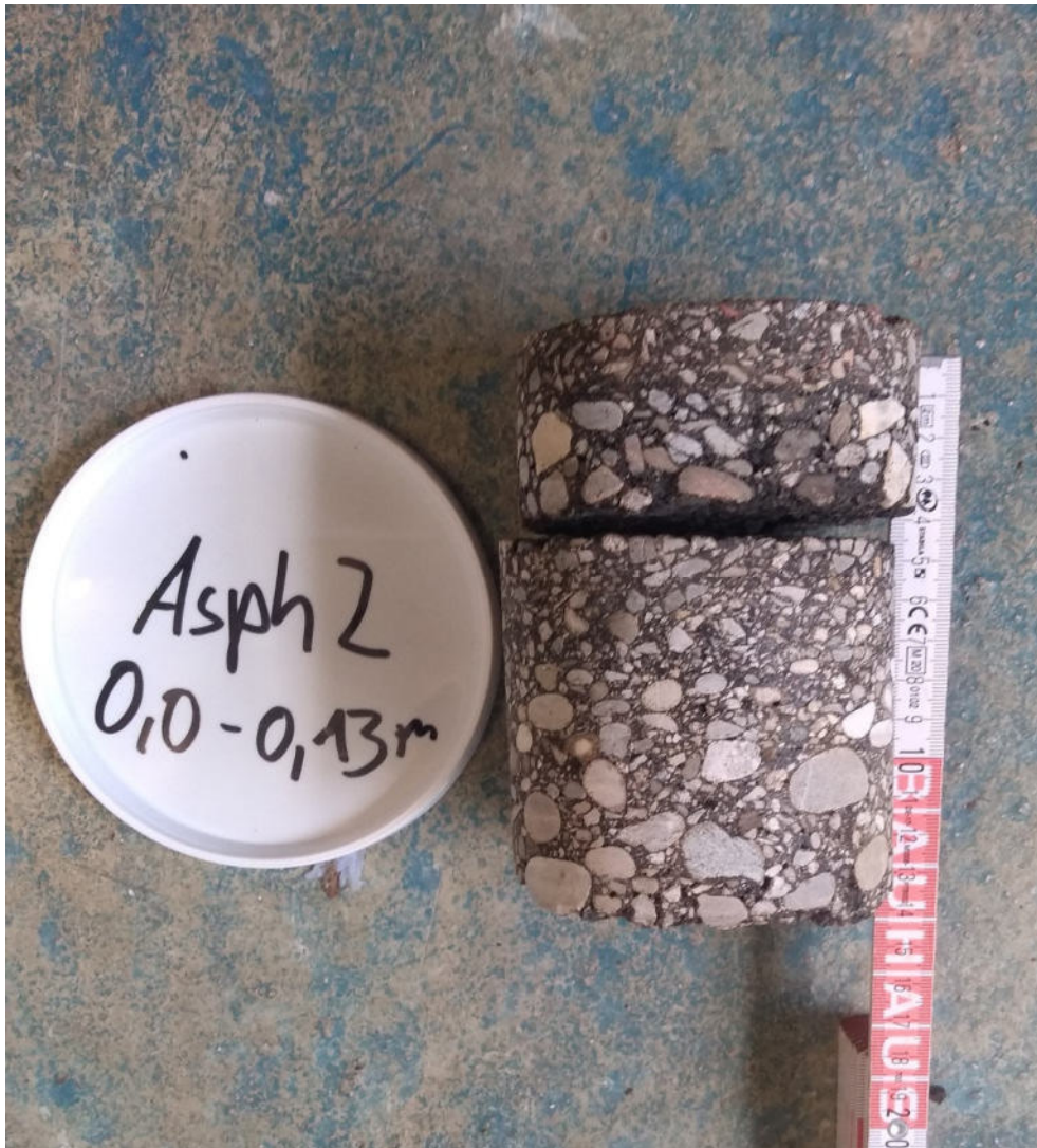
Abb. 2, 23.08.2023: Asphaltbohrkern Asph 2, Stärke Asphalt 13 cm
