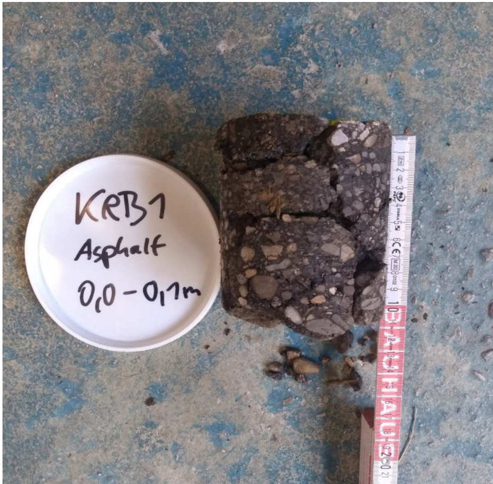
Abb. 1, 23.08.2023: Asphaltbohrkern bei KRB 1 (Asph 1), Stärke Asphalt 10 cm
