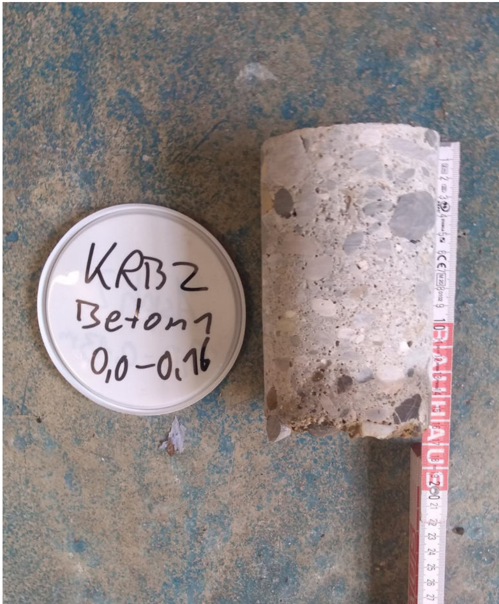
Abb. 3, 23.08.2023: Betonbohrkern bei KRB 2 (Beton 1), Stärke Beton 16 cm
