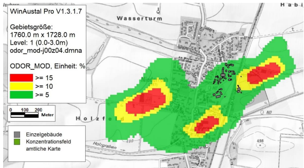
Abbildung 6: Belastung für Geruch pro Jahr in % durch die geruchsrelevanten Anlagen in Niederroth, Ausbreitungsrechnung mit AKTerm Erding, Auswertung Netz 4, Quelle Karte: Bayerische Vermessungsverwaltung
